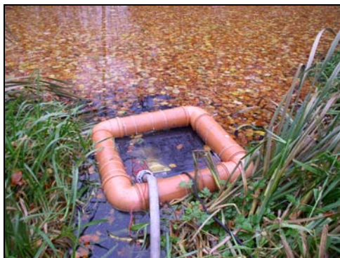
Abbildung 12: Einsatz der Tauchpumpe für die experimentelle Beschickung der Bodenfilter.
